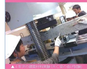
▲4年次の建築材料実験(RC梁の曲げ試験)
