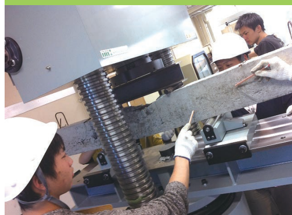
▲4年次の建築材料実験(RC梁の曲げ試験)
