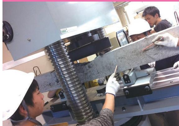
▲4年次の建築材料実験(RC梁の曲げ試験)
