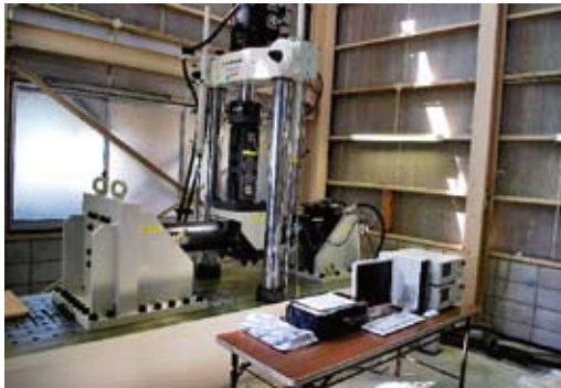
◀ 300kN 油圧サーボ 2 軸疲労試験装置 The 300kN hydraulic servo test system
