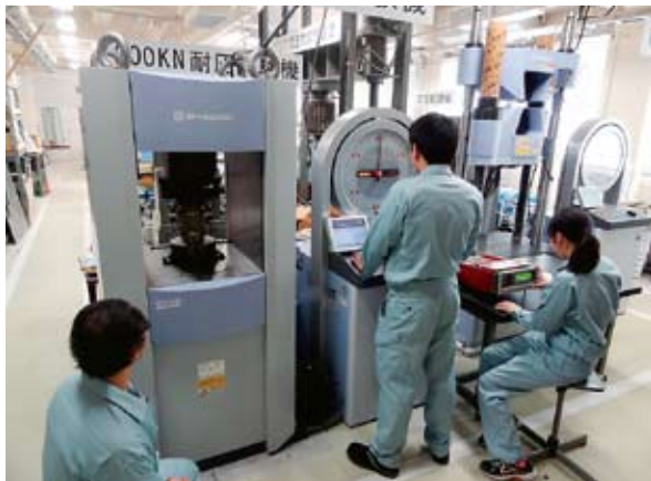
▲ 建設工学創造実験の一例：コンクリートの圧縮試験 Measurements and experiments of the compression test of concrete
