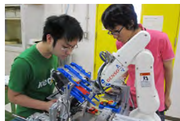
工夫点 エアシリンダを用いて、ブロックを完全に組み付けできるようにした。
