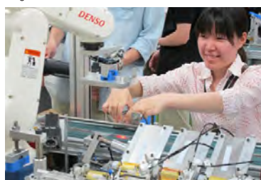
工夫点 アームの工数を減らし、アクチュエータに分散させ、工程の短時間化を図った。
