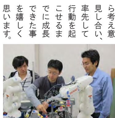
工夫点 色指定部品の供給構造にインデックス方式を採用、センサーで色を識別する。
