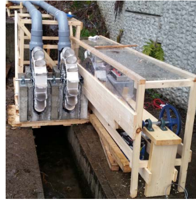
豊田高専製作同軸2連胸掛水車と増速装置
